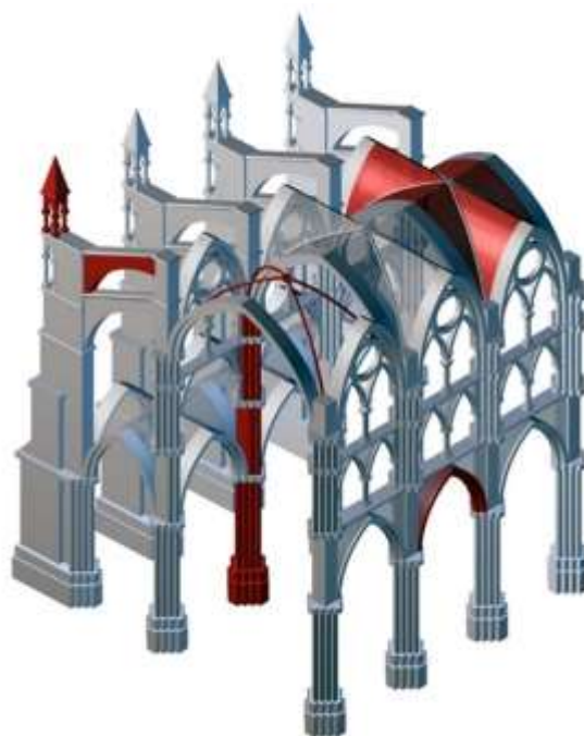
Ryc. 76. Schemat konstrukcji sklepienia krzyżowo żebrowego
